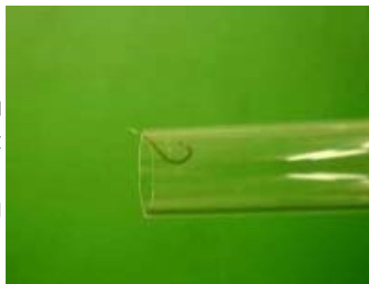
図 11 流線袖針による吸込み実験
