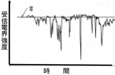
フェージング(Fading)とは気象条件により受信する電波の強さが変動、減衰すること。
